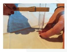
➤ Placer le morceau de magnésium dans l'acide, et couvrir avec le tube à essai en Pyrex, comme illustré
